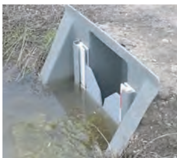
流出を抑制する落水量調整装置の例
